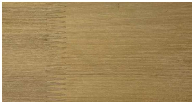
Das Holz der Robinie ist schwer und hart mit entsprechend guten Festigkeitswerten. Es ist schwer spaltbar, zäh und elastisch. Robinie zeichnet sich durch eine überdurchschnittliche Belastbarkeit bei dynamischer Beanspruchung aus. Die Schwindmaße sind gemessen an der hohen Rohdichte niedrig. Einmal getrocknet besitzt das Holz ein gutes Stehvermögen. Bedingt durch Faserabweichungen und Wuchsspannungen kann es zu Rissen und Verwerfungen führen.
