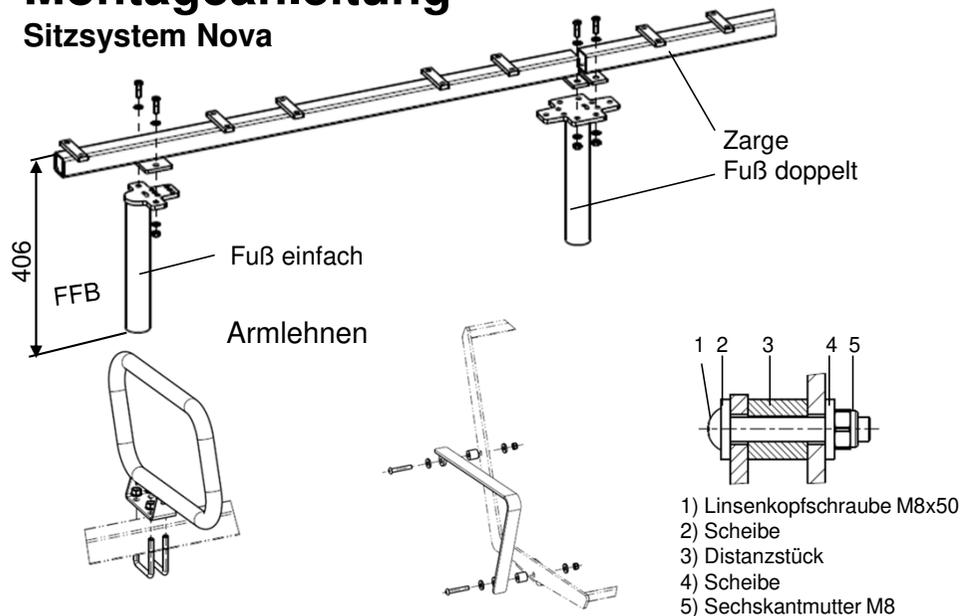
Anziehdrehmoment A2-70 Schrauben: M6 – 6 Nm, M8 – 16 Nm, M10 – 32 Nm. Auf festen Sitz der Verschraubungen achten! Um ein „Fressen“ vom Gewinde zu verhindern, kann eine aufgesprühte PTFE-Trockenschicht verwendet werden. Pflege- und Reinigungshinweise siehe unter [www.erlau.com](http://www.erlau.com)
