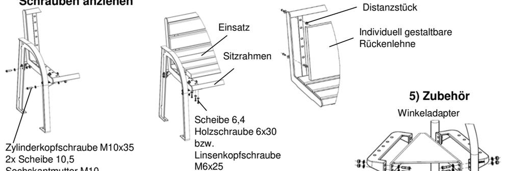
Anziehdrehmoment A2-70 Schrauben: M6 – 6 Nm, M8 – 16 Nm, M10 – 32 Nm. Auf festen Sitz der Verschraubungen achten! Um ein „Fressen“ vom Gewinde zu verhindern, kann eine aufgesprühte PTFE-Trockenschicht verwendet werden. Pflege- und Reinigungshinweise siehe unter [www.erlau.com](http://www.erlau.com)
