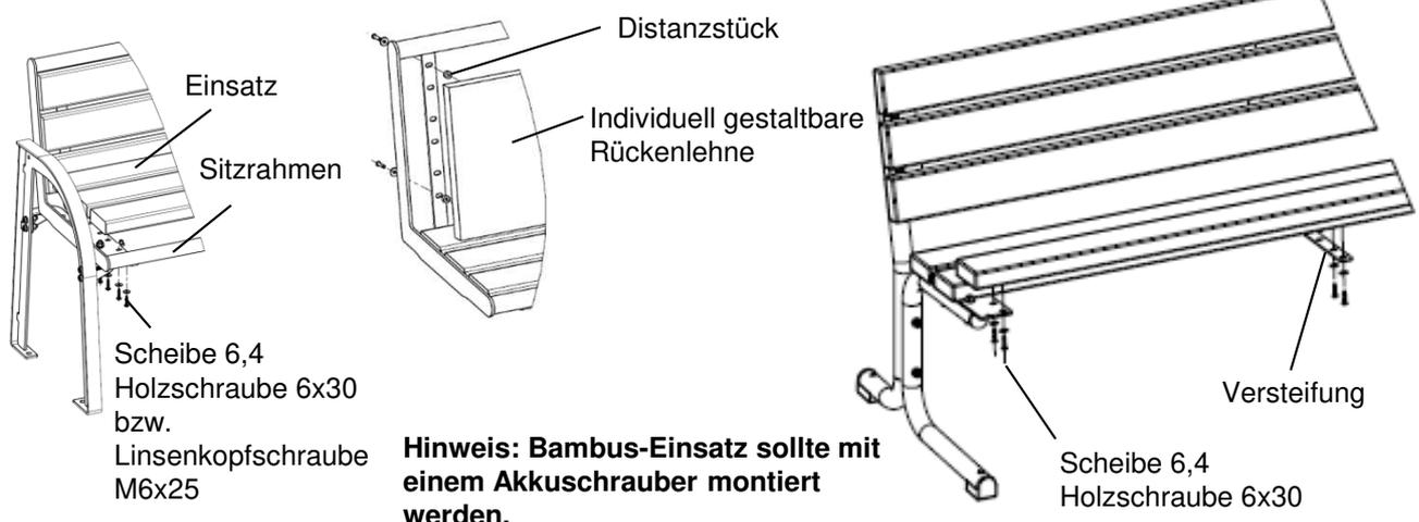
Anziehdrehmoment A2-70 Schrauben: M6 – 6 Nm, M8 – 16 Nm, M10 – 32 Nm. Auf festen Sitz der Verschraubungen achten! Um ein „Fressen“ vom Gewinde zu verhindern, kann eine aufgesprühte PTFE-Trockenschicht verwendet werden. Pflege- und Reinigungshinweise siehe unter [www.erlau.com](http://www.erlau.com)
