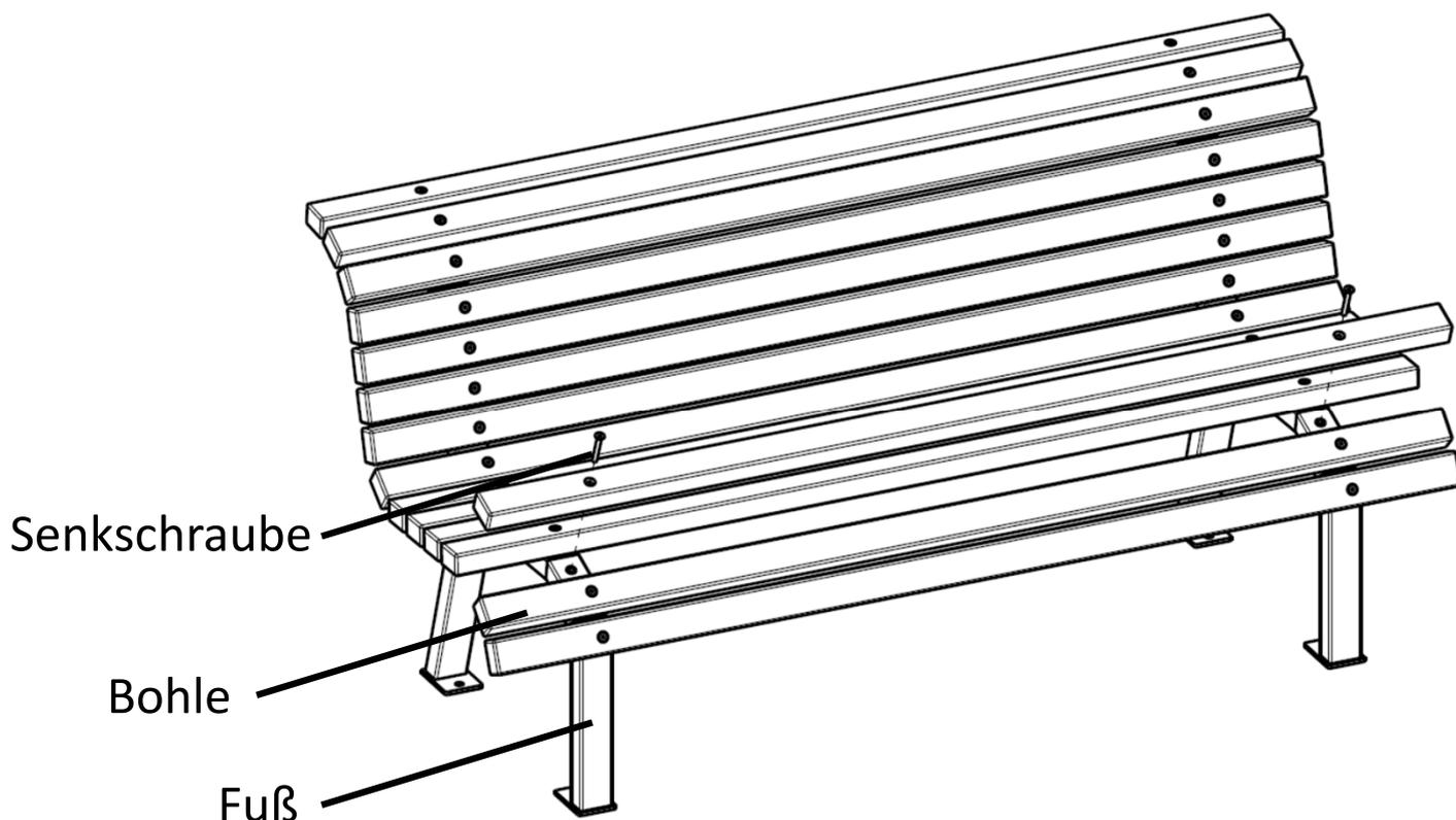
Anziehdrehmoment A2-70 Schrauben: M6 – 6 Nm, M8 – 16 Nm, M10 – 32 Nm. Auf festen Sitz der Verschraubungen achten! Um ein „Fressen“ vom Gewinde zu verhindern, kann eine aufgesprühte PTFE-Trockenschicht verwendet werden. Pflege- und Reinigungshinweise siehe unter [www.erlau.com](http://www.erlau.com)
