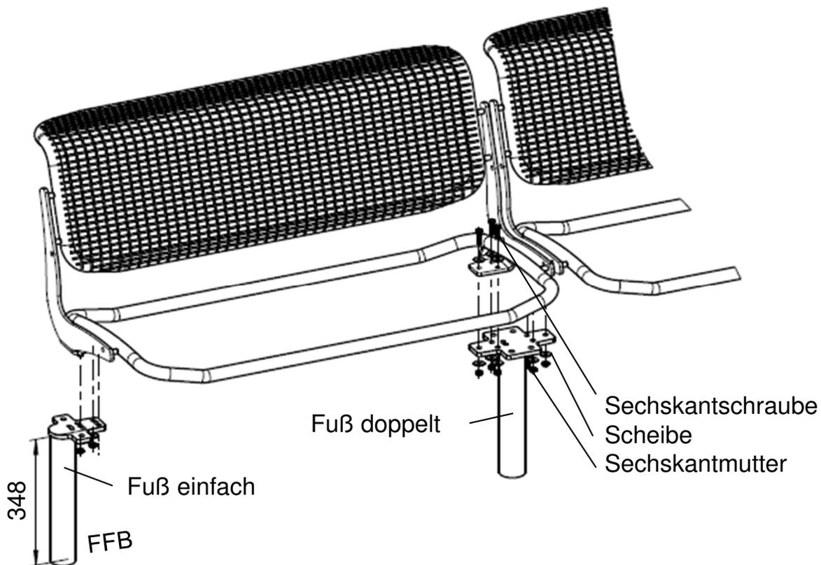
Anziehdrehmoment A2-70 Schrauben: M6 – 6 Nm, M8 – 16 Nm, M10 – 32 Nm. Auf festen Sitz der Verschraubungen achten! Um ein „Fressen“ vom Gewinde zu verhindern, kann eine aufgesprühte PTFE-Trockenschicht verwendet werden. Pflege- und Reinigungshinweise siehe unter [www.erlau.com](http://www.erlau.com)
