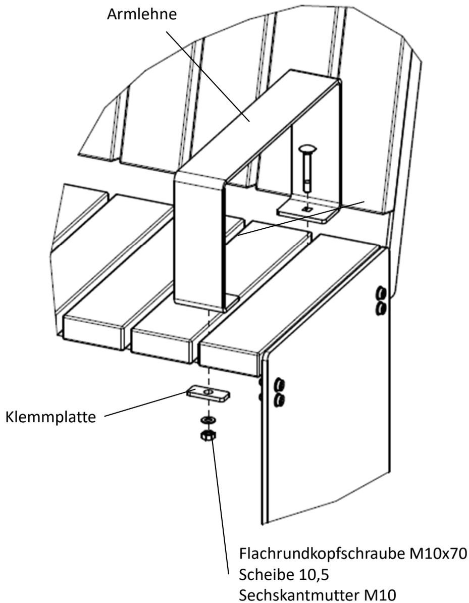
Anziehdrehmoment A2-70 Schrauben: M6 – 6 Nm, M8 – 16 Nm, M10 – 32 Nm. Auf festen Sitz der Verschraubungen achten! Um ein „Fressen“ vom Gewinde zu verhindern, kann eine aufgesprühte PTFE-Trockenschicht verwendet werden.
