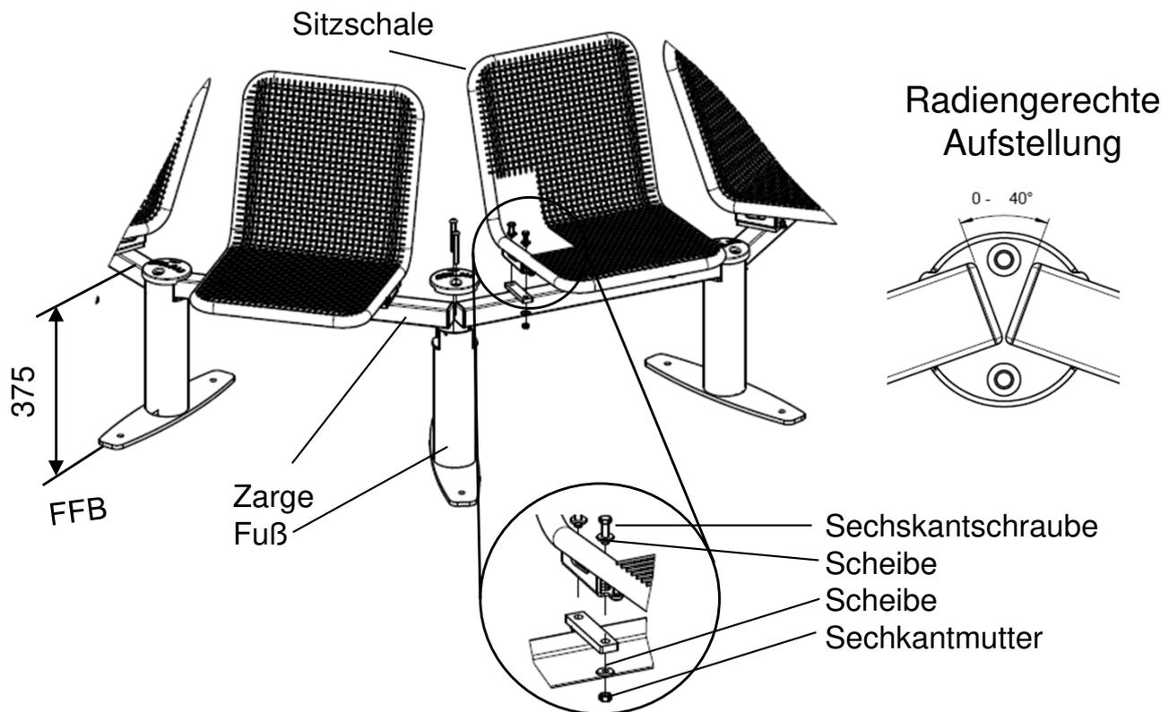
Anziehdrehmoment A2-70 Schrauben: M6 – 6 Nm, M8 – 16 Nm, M10 – 32 Nm. Auf festen Sitz der Verschraubungen achten! Um ein „Fressen“ vom Gewinde zu verhindern, kann eine aufgesprühte PTFE-Trockenschicht verwendet werden. Pflege- und Reinigungshinweise siehe unter [www.erlau.com](http://www.erlau.com)
