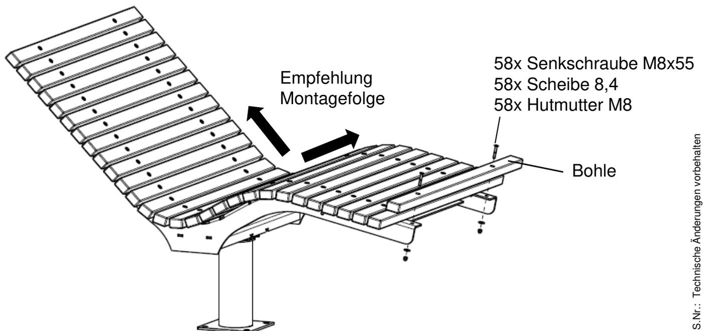
Anziehdrehmoment A2-70 Schrauben: M6 – 6 Nm, M8 – 16 Nm, M10 – 32 Nm. Auf festen Sitz der Verschraubungen achten! Um ein „Fressen“ vom Gewinde zu verhindern, kann eine aufgesprühte PTFE-Trockenschicht verwendet werden.
