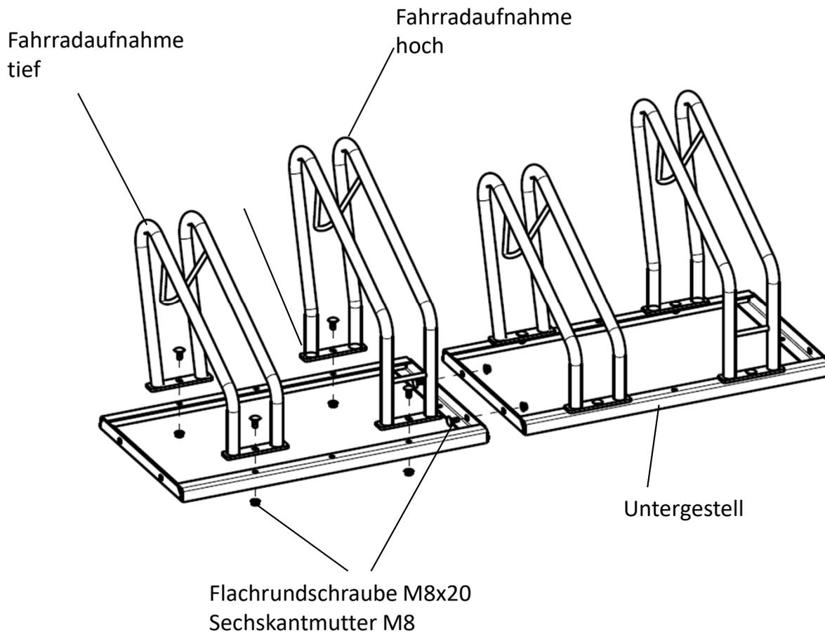
Anziehdrehmoment A2-70 Schrauben: M6 – 6 Nm, M8 – 16 Nm, M10 – 32 Nm. Auf festen Sitz der Verschraubungen achten! Um ein „Fressen“ vom Gewinde zu verhindern, kann eine aufgesprühte PTFE-Trockenschicht verwendet werden.
