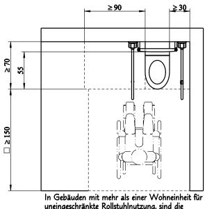
In Gebäuden mit mehr als einer Wohneinheit für uneingeschränkte Rollstuhlnutzung, sind die Zugangsseiten zur Toilette abwechselnd rechts oder links vorzusehen.
